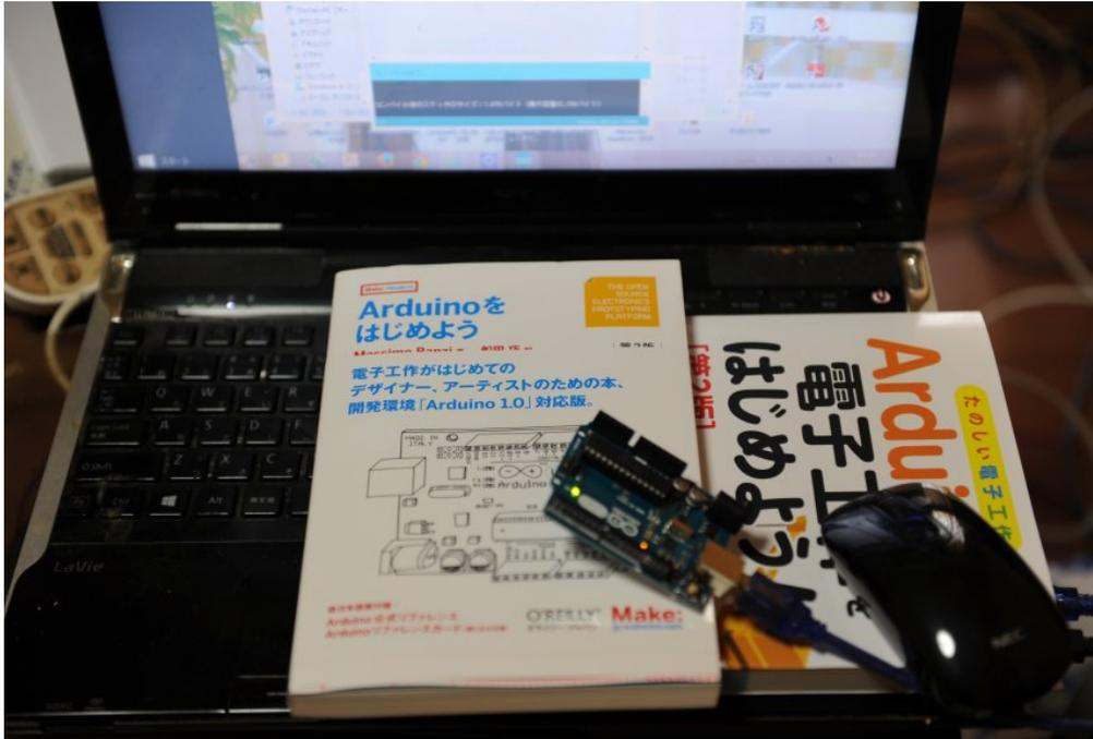
写真は arduino に最初からデジタルの 13 に接続されている LED を点滅させているところです。プログラム (arduino ではスケッチと呼ぶようです)
