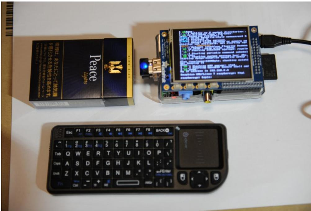
これは Raspberry Pi type B を使って小さなコンピュータを組み立ててみたものです。タバコの箱ぐらいの大きさです。配線を電源だけにするために
