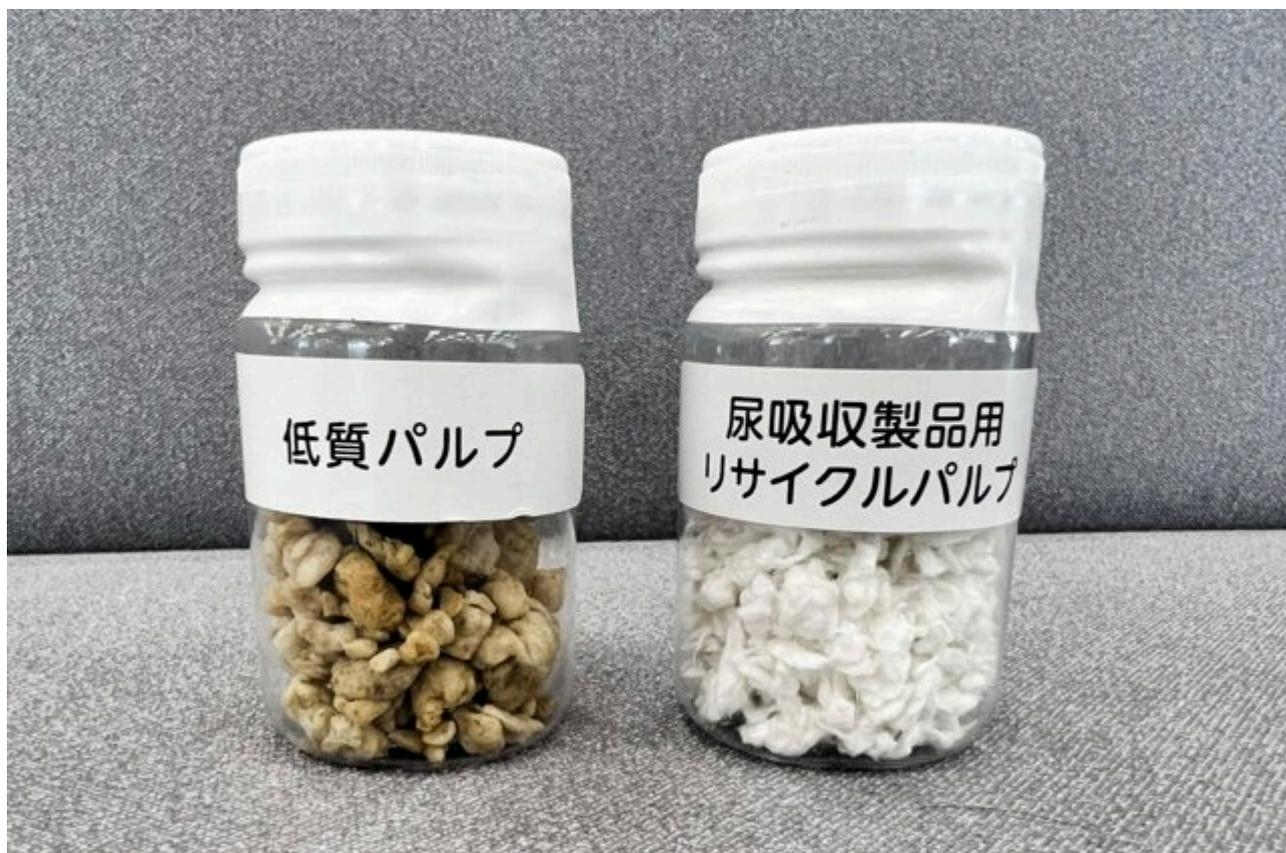
回収した使用済み紙おむつから取り出したパルプ(左)と、オゾン処理したリサイクル向けパルプ=ユニ・チャーム提供
